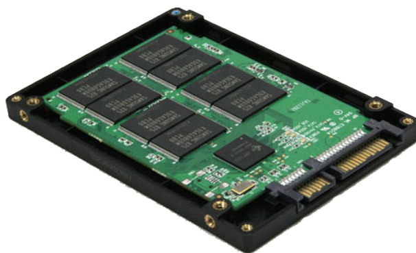
Imagen de una unidad de estado sólido. Los módulos de memoria son electrónicos.
