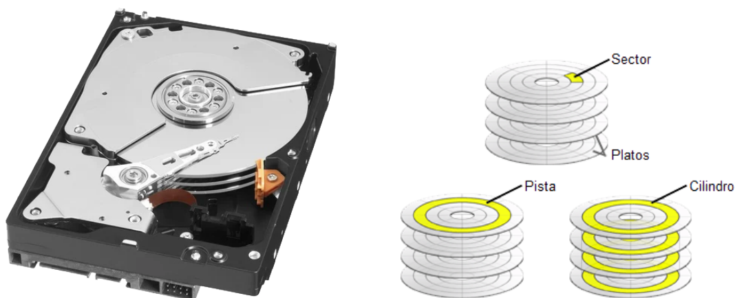
Imágenes de un disco duro magnético y de sus partes. Los platos rotan y la cabeza requiere un movimiento mecánico.
